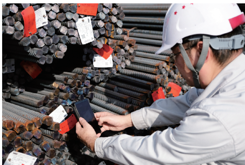
手机扫二维码“验货”,从建材安全的源头保障了建设的高质量。
