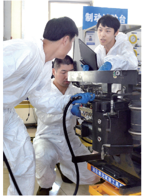
秦鼎原(右一)和同事在对刚维修完的液压制动单元进行测试。
