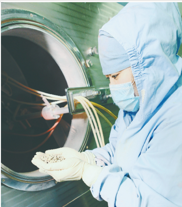
科技发展集团亦庄分厂片剂车间操作员查看薄膜包衣设备中的药品
