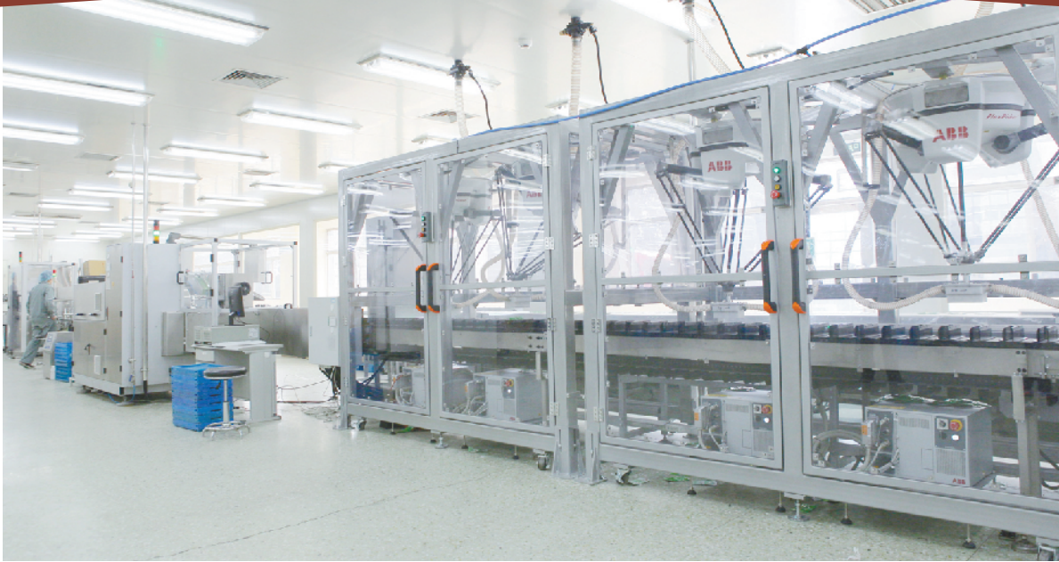
科技发展集团亦庄分厂颗粒车间包装连线ABB自动抓取设备
