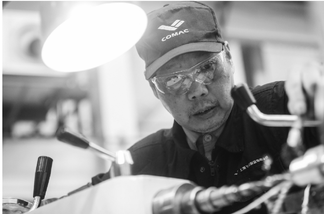
图为施品芳在加工国产大型客机C919的气密试验接头。这一个零件他足足做了两个多小时。
