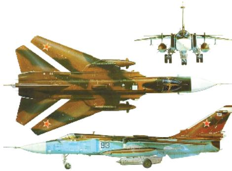
苏-24是苏联苏霍伊设计局设计的双座双发动机变后掠翼设计之低高度长程多用途攻击/战术轰炸机。除了携带传统的空对地导弹等武装进行攻击任务外，苏-24也可携带小型战术核武器，进行纵深打击。
