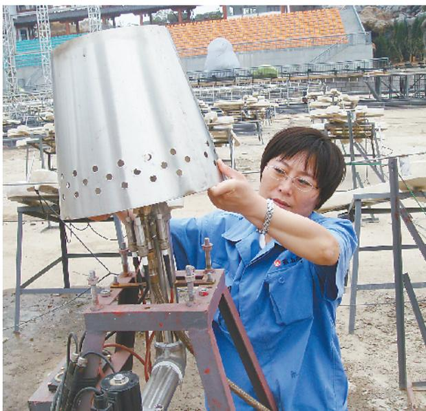
高春梅在用仪器进行火炬燃烧试验
