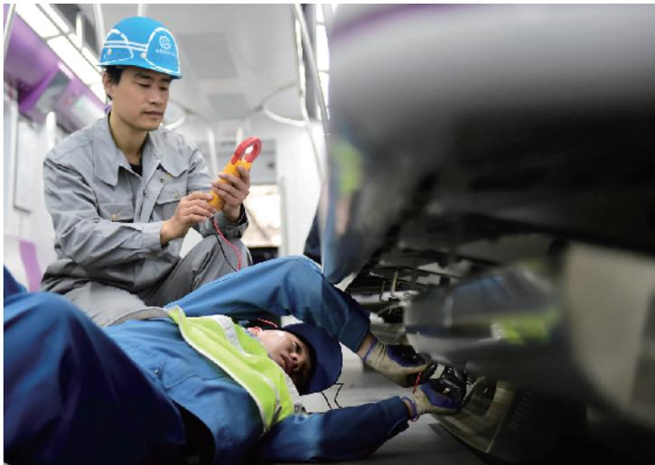
许鹏程用万用表测量电加热器的电压
