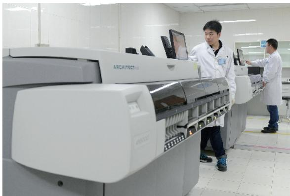
全自动生化分析仪。该设备适用于肝功能、肾功能、心肺功能等疾病诊断和筛查，具有检测速度快、检验结果准确可靠等特点，被行业评为“世界级的临床生化检测”。
