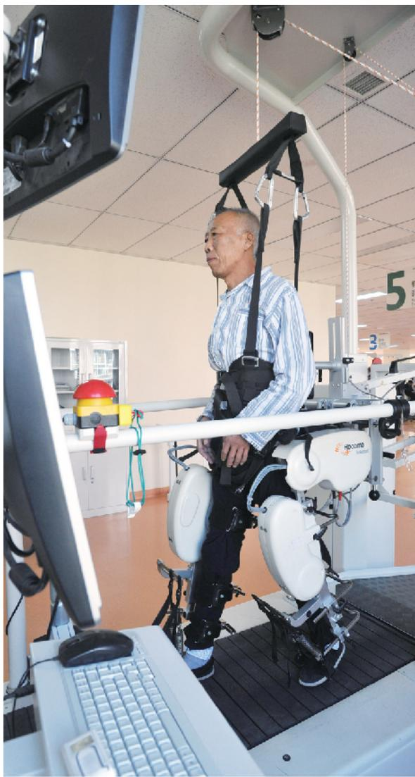
下肢康复机器人。这台美国进口设备代替传统人工减重步行治疗，可以实现正常人的正确步态，达到左右腿同时训练。它帮助很多暂时不具备站立和行走能力的患者，加快神经损伤的康复，使更多的患者恢复步行能力，重新走向社会。
